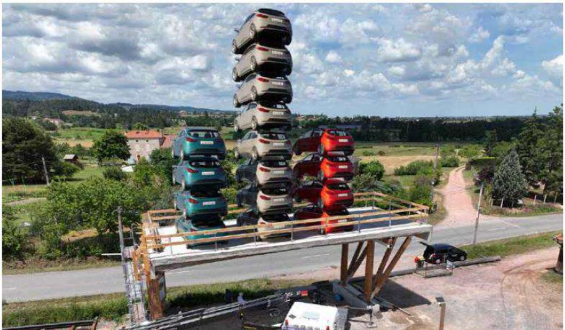
Sous 24 Tonnes de chargement, soit l'équivalent de 16 véhicules de 1,5T, la flèche est de l'ordre de 8mm alors que la flèche théorique admise est de  $1/400^e$ , soit 32mm selon la norme NF EN 1995-2 :2005.
